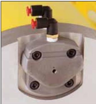
**Z-Stop:** Der optionale Z-Stop ist eine patentierte Vorrichtung, die das Absinken aufgehängter Lasten oder Werkzeuge beim Ausschalten oder nachts verhindert, wenn die Luftzufuhr abgeschaltet ist. Der Z-stop stoppt das Absinken innerhalb von 152,4 mm, sperrt die Druckluft des Balancers mechanisch und verhindert dadurch eine Beschädigung von Werkzeugen oder Objekten unter der aufgehängten Last. Erhältlich für alle Geräte mit einem Durchmesser von 254 mm.
