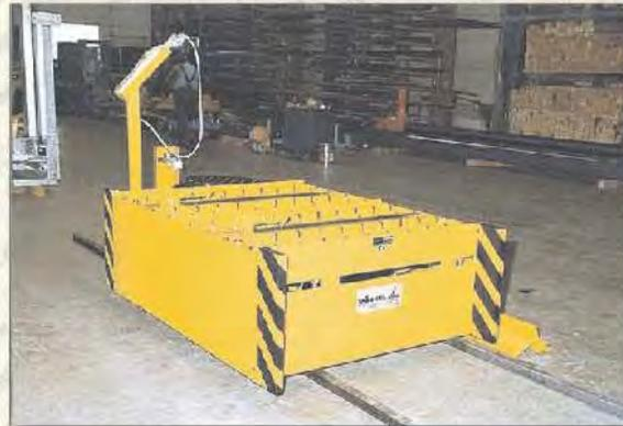
**Werkzeugwechselwagen frei verfahrbar mit vollelektronischer Vierradlenkung**
